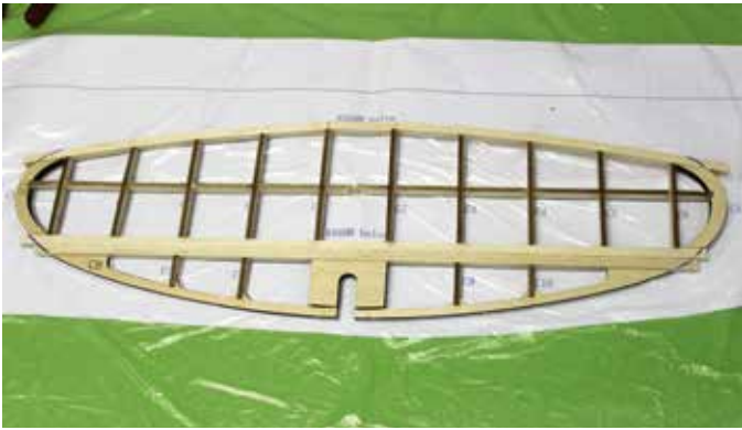
Die Laserteile des Bausatzes und die Passgenauigkeit sind gut. Das Höhenleitwerk ist profiliert
