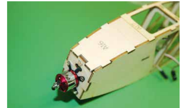
Montage des kleinen Brushless-Motors am Rumpfspant. Das Ganze wird noch mit Holz umkleidet
