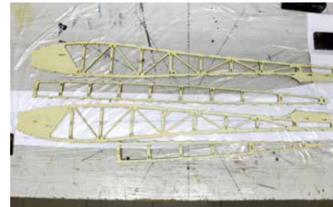
Fertigrumpfteile bereit zur Montage als Rumpferüst
