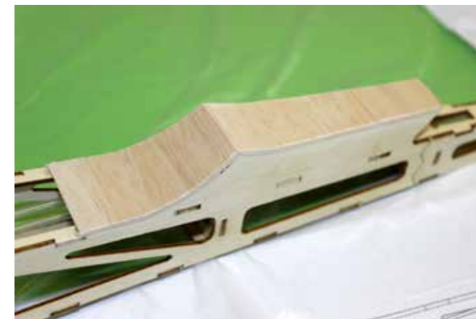
Die Auflage des Höhenleitwerks bewirkt eine EWD von -5° und sollte gleich auf +2° angepasst werden
