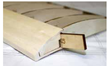
Ein solider Verbinder sorgt für den erforderlichen V-Winkel der Flügel. Gut zu sehen: Die ursprünglich eckige Nasenleiste
