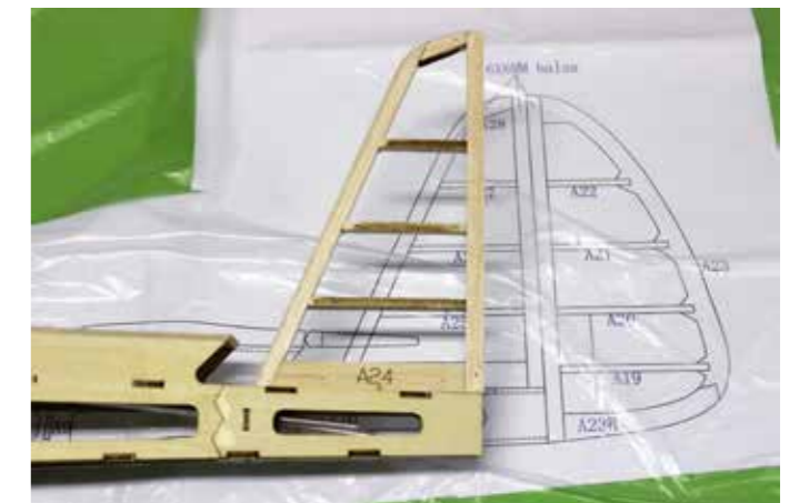
Die Seitenleitwerks-Dämpfungsfläche wird auf den Rumpf geklebt und das Ruder mit Vliesscharnieren angeschlagen
