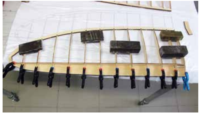
Die untere vordere Flügelbeplankung wird zuerst an Rippen und Holmkamm befestigt, dann die obere und daran die Nasenleiste
