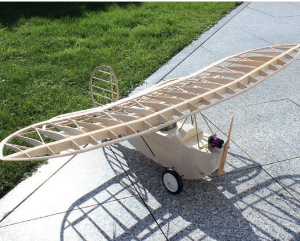
Vor der Bespannung mit Oratex Bespanngewebe sind vor allem die Rippen mit Heißsiegelkleber einzustreichen
