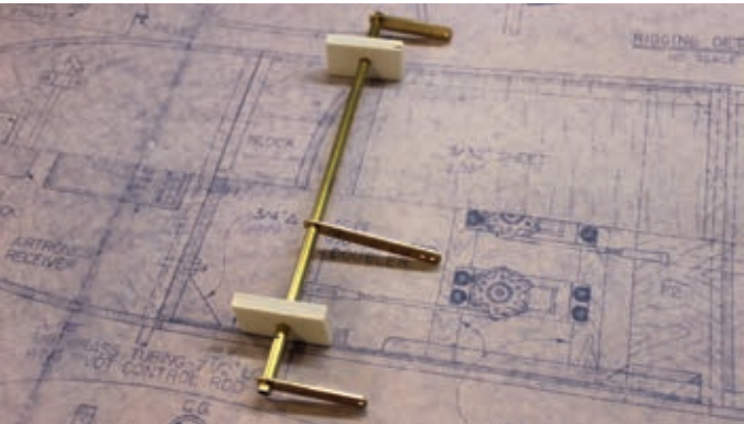
Die Höhenruder-Ansteuerung ist später im Rumpf eingesetzt
