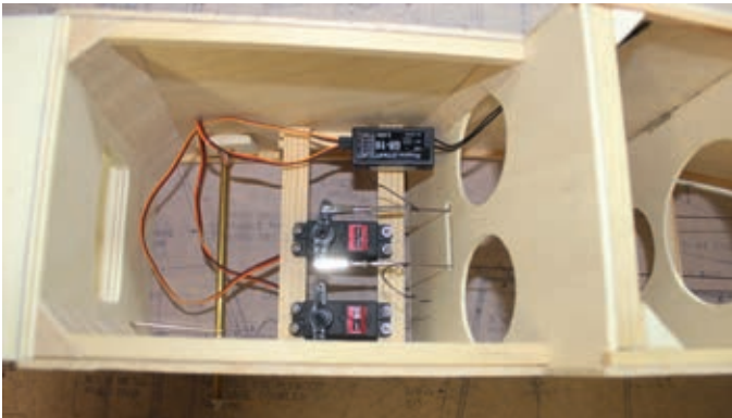
Zwei Servos reichen zur Steuerung. Das Seitenruder wird über Seilzüge gesteuert
