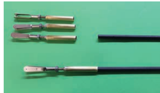
Das werden die Anlenkungsstangen aus CFK-Rohr für die vordere Fläche (Höhenruder)
