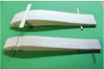
Auf Basis der Musterrippen entstehen Rippenblöcke für vordere und hintere Fläche
