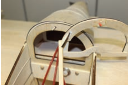
Hier gut erkennbar ist die spätere Arretierungsmethode der Kabinenhaube
