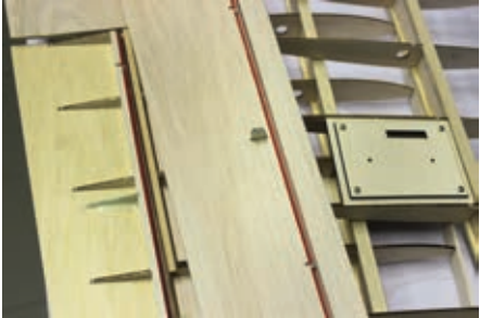
Letztlich sind die Querruder einfache Dreiecksstrukturen – jedoch lassen sie sich auch später demontieren
