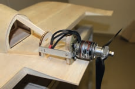
Die Position von Motor beziehungsweise Propeller hinter der Flügelkante lässt sich individuell anpassen
