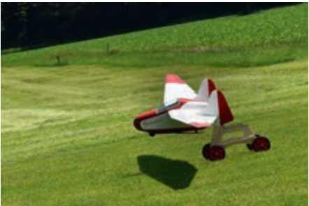
In der Fauvel ist eine Schleppkupplung verbaut. Der Startwagen hilft sehr. Eigenstart mit Motor ist aber auch machbar
