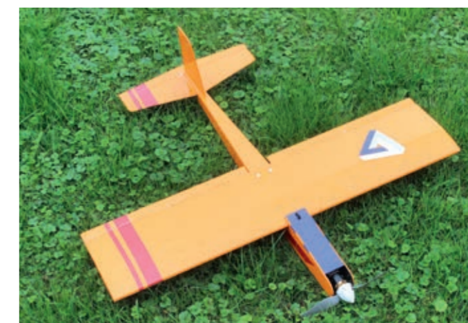
Bespannt mit Oracover-Folie kann man dem Cafe-Racer ein Design nach eigenen Vorstellungen verpassen
