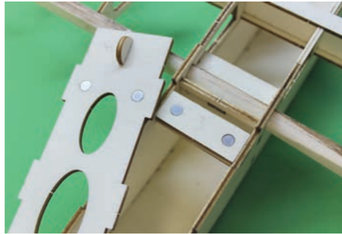
Rumpfdeckel mit Magneten und die Zapfenkonstruktion sorgen für einen sicheren Einbau
