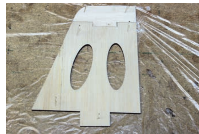
Der Cafe-Racer wird ohne Seitenruderfunktion geflogen, sodass das Leitwerk sehr stabil ausfällt
