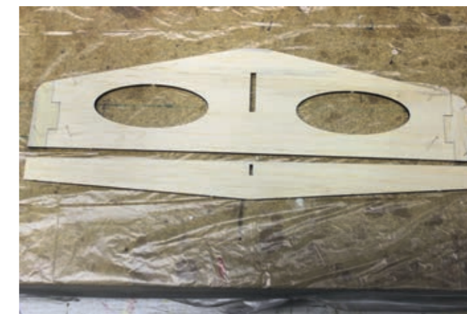
Die Laserschnitte sind sauber ausgeführt und das Höhenleitwerk solide konstruiert
