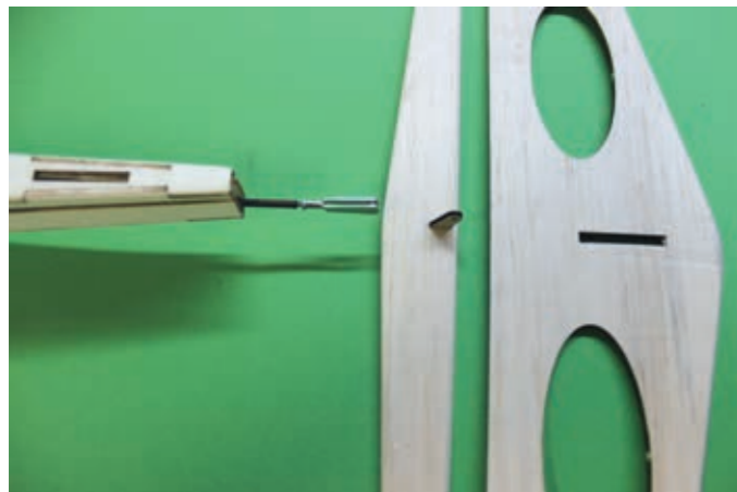
Praktischerweis kann die CFK-Schubstange zur Anlenkung des Höhenruders direkt aus dem Rumpfende austreten
