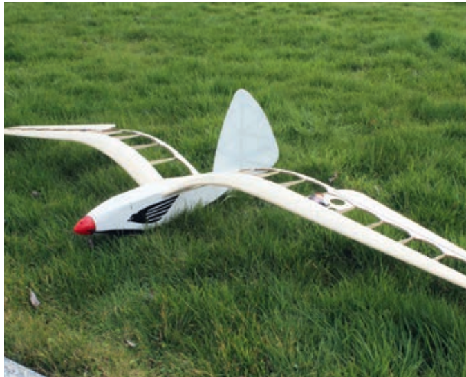
Rumpf und Leitwerk sind bespannt. Die Flügel zu bespannen ist nicht trivial, aber auch kein Hexenwerk
