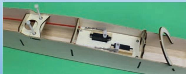
Beide Servos zur Steuerung von Höhen- und Seitenruder sitzen im Bereich unter der Tragfläche
