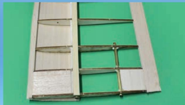
Flügelwurzel mit Steckungsrohren und Verstärkungen
