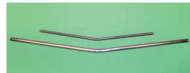
Der 4- und 6-mm-Steckungsstahl machen die 15° V-Form sichtbar
